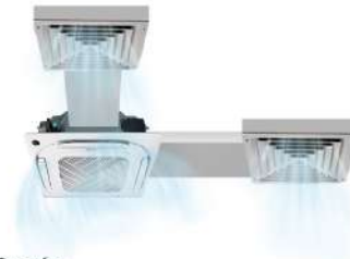
Dos vías 71 a 170 - Flujo de aire en el conducto 300-500 m 3 /h. Longitud máxima del conducto: 1,5 metros.
