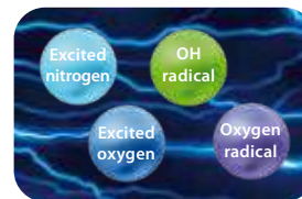
Los electrones colisionan y se mezclan con el nitrógeno y el oxígeno del aire para formar cuatro tipos de elementos
