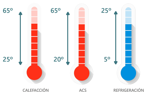
TEMPERATURA DE IMPULSIÓN DEL AGUA
