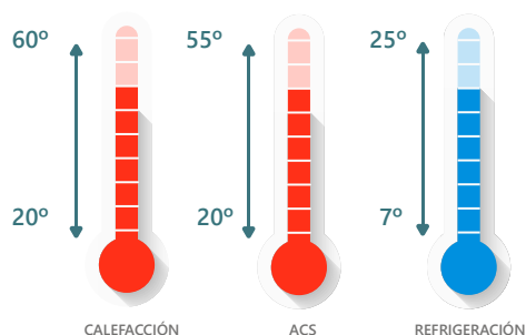
TEMPERATURA DE IMPULSIÓN DEL AGUA
