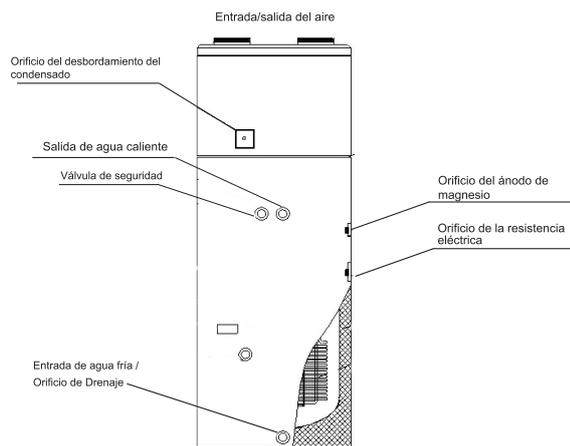
Conexión salida agua caliente: 3/4" macho
