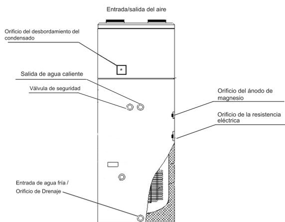
Conexión salida agua caliente: 3/4" macho
