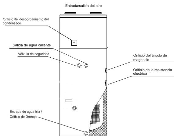
Conexión salida agua caliente: 3/4" macho
