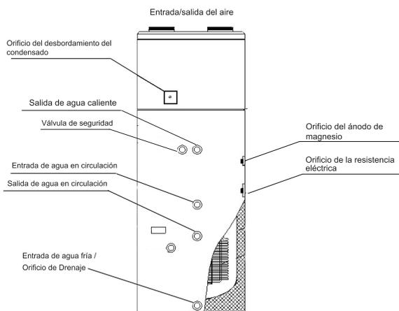
Conexión salida agua caliente: 3/4" macho
