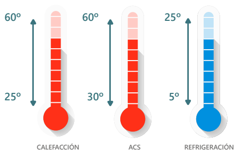
TEMPERATURA DE IMPULSIÓN DEL AGUA
