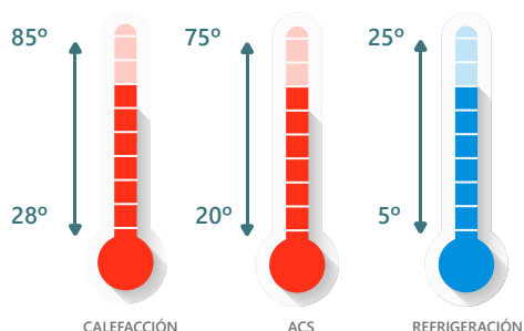
TEMPERATURA DE IMPULSIÓN DEL AGUA
