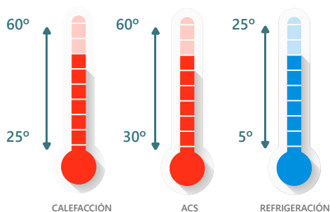
TEMPERATURA DE IMPULSIÓN DEL AGUA
