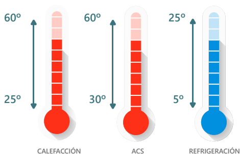
TEMPERATURA DE IMPULSIÓN DEL AGUA
